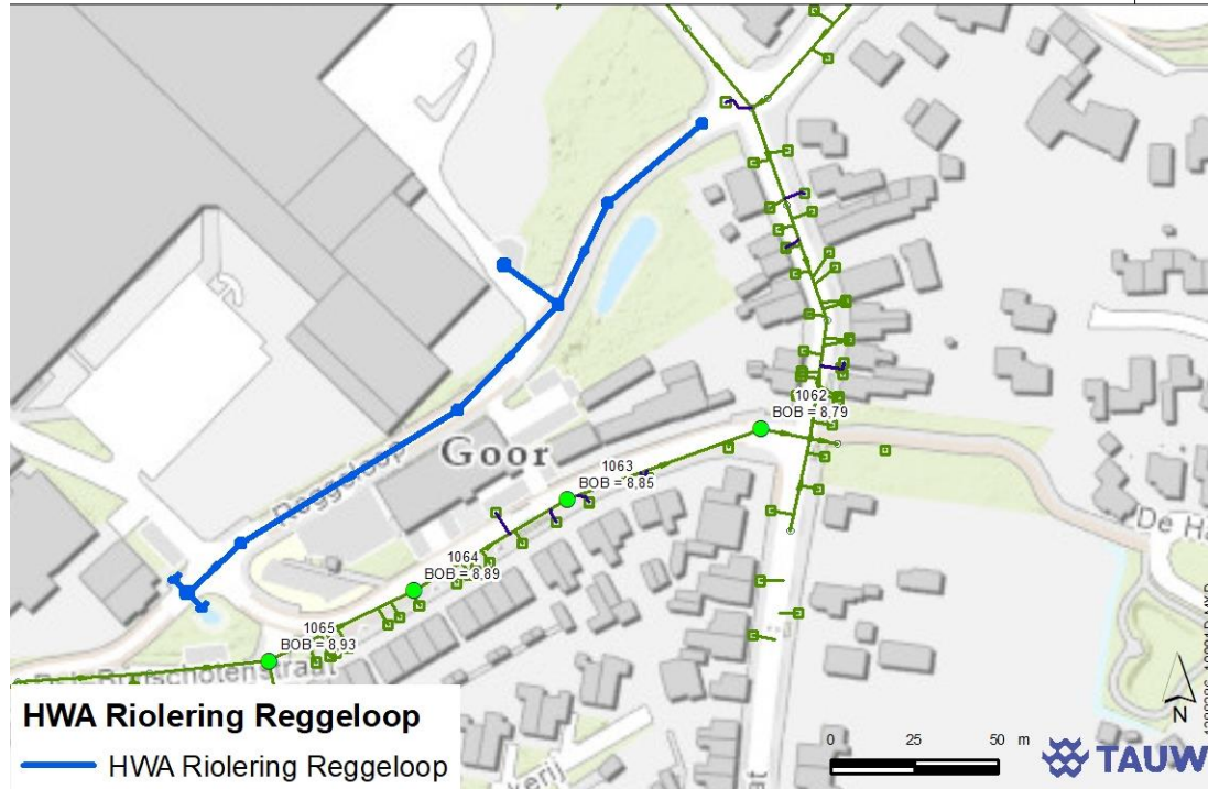
Figuur 2.19 Overzicht hemelwaterriool Reggeloop (bron riooltekening gemeente)
