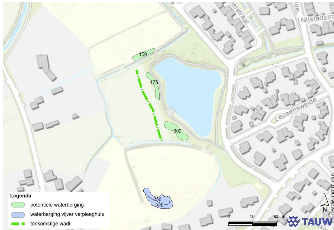
Figuur 3.4 Ligging wadi's en potentiële berging op onverhard terrein (voor gebieden met potentie extra berging is het oppervlak als label opgenomen)
