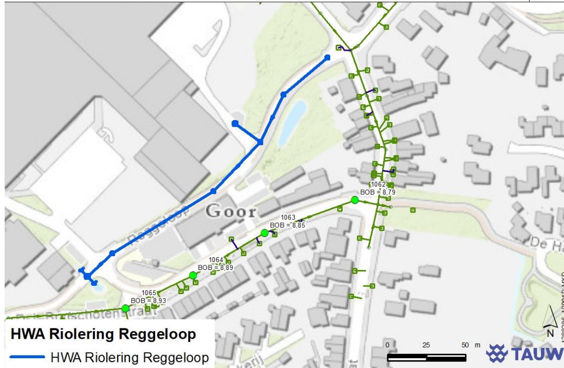
Figuur 2.19 Overzicht hemelwaterriool Reggeloop (bron riooltekening gemeente)
